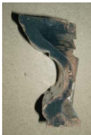
41. kép. Zsengélés és mázazás után kettévágott párkányelem.
