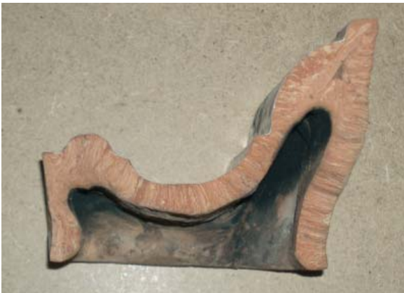
34-36. kép. A csempe anyagának rétegződése.
