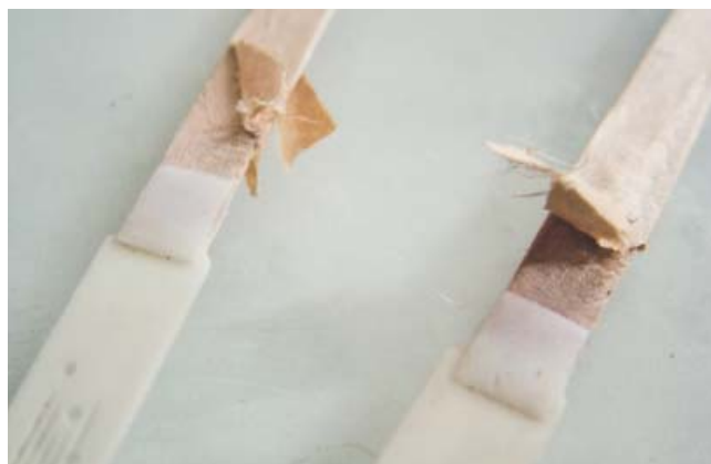
8. kép. Küllők ragasztása alátámasztással (Faragó 2007).
