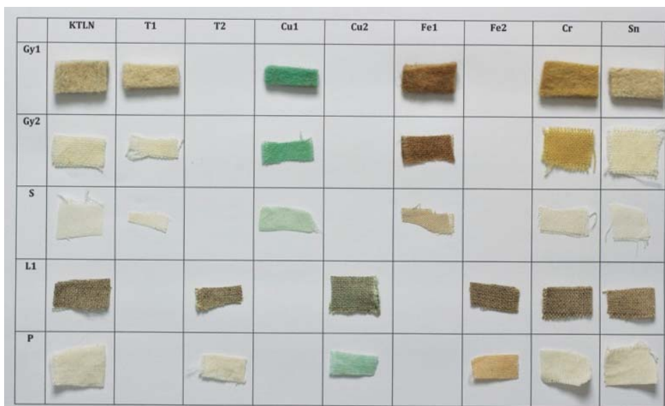
2. kép. Az SEM-EDX vizsgálatokhoz használt pácolt standard minták (Gardánfalvi M. felvétele).
