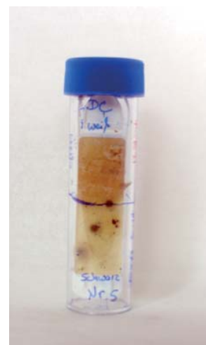
8.a-b. kép. Mintavétel Envirocheck®Contact teszttel és eredménye inkubálás után (a szerző felvétele).
