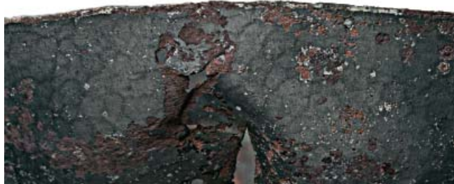
7. kép. A planírozó kalapács lenyomata az ónozáson keresztül is látható (Bicskei József felvétele).
