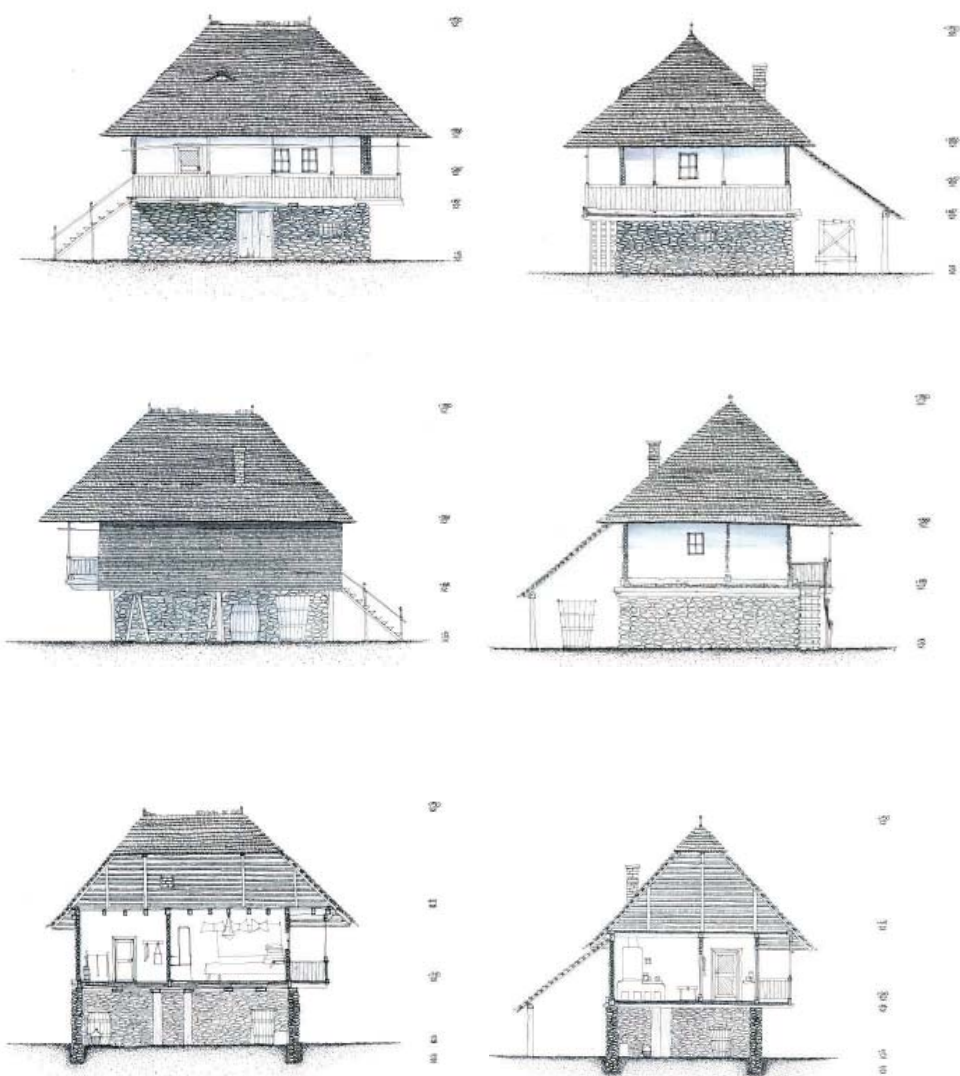
Fig. 14-19. Casa din Jugur Mușcel, relevee și secțiuni 11 .
