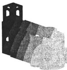
Fig.4 Deplasări în gruparea fundamentală - mediu deformabil
