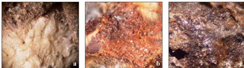
Fig. 3. Microstructuri: a. Integrate în crusta de coroziune; b. Cu depozite de coroziune din etapa intermediară de alterare; c. Microstructuri și depozite de compuși chimici
