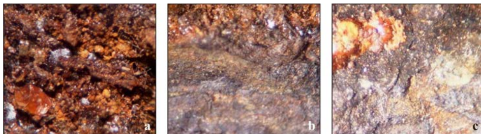
Fig. 2. a. Strat exterior cu depozite de compuși chimici secundari; b. Crusta de coroziune neuniformă (compuși chimici primari și secundari); c. Microstructuri de coroziune
