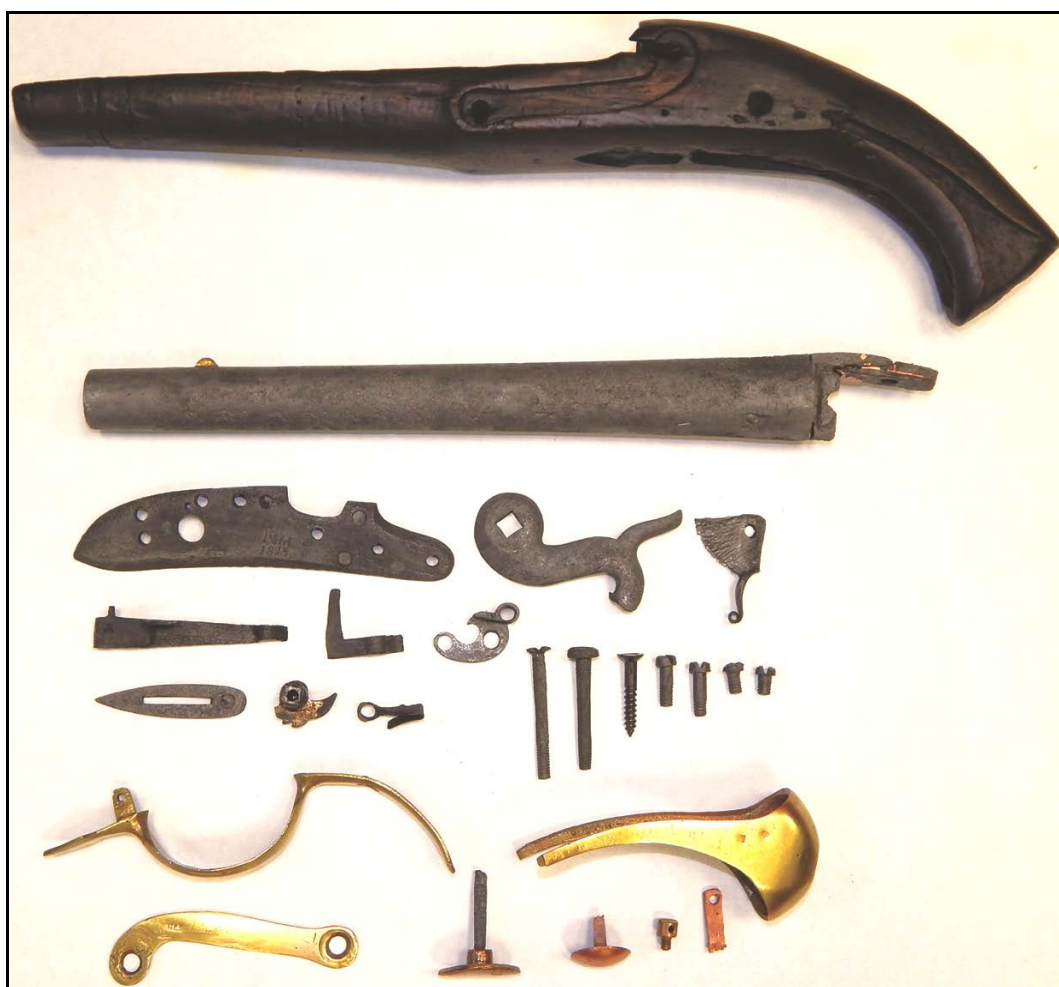
Fig. 4. Subansamblele pistolului după curățare.
