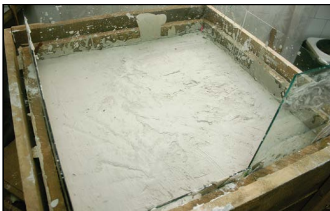
Fig. 24. Încărcarea la nivel a bazei de ipsos a vetrei cruciforme (foto: D. Bostan, 2010).
