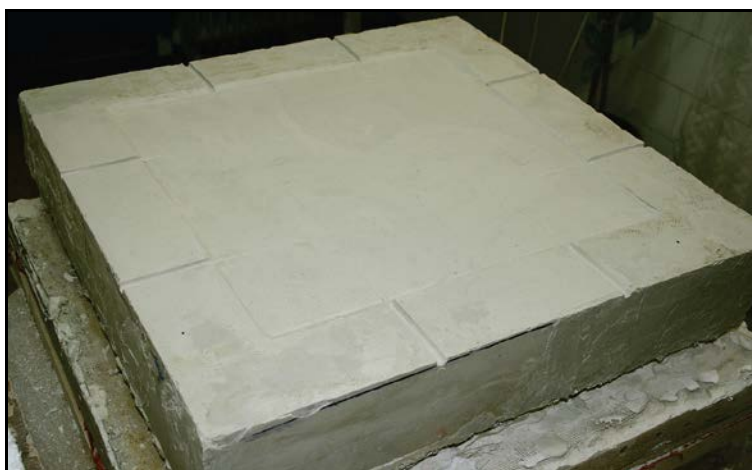
Fig. 26. Crearea unei suprafețe regulate a bazei de ipsos (foto: D. Bostan, 2010).
