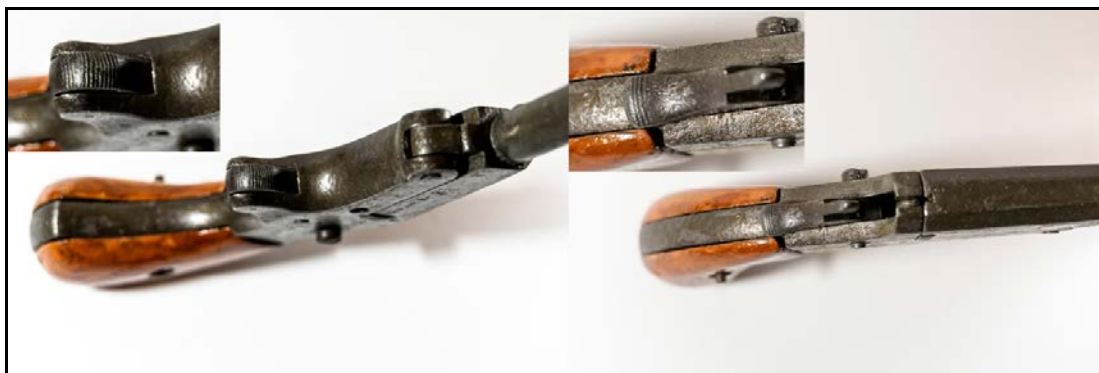
Fig. 5. Incizii orizontale pe trăgaci și cocoș-percutor, cu scopul îmbunătățirii aderenței la folosire.
