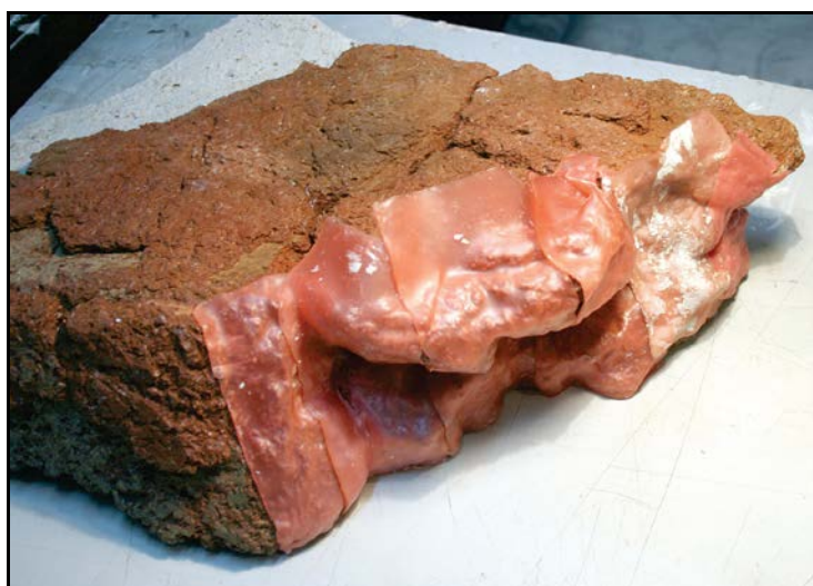
Fig. 47. Izolarea marginilor fragmentelor mari cu folii de ceară dentară (foto: D. Bostan, 2009).
