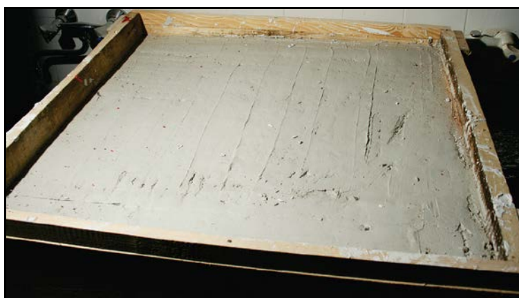
Fig. 14. Încărcarea la nivel a negativului de ipsos (foto: D. Bostan, 2010).
