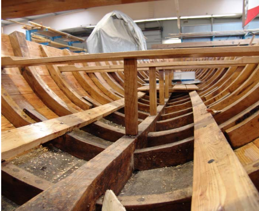
Abb. 10: Innenraum des Typs Oberstimm 1, mittig unter den Ruderbänken (Duchten) die Duchtstützen
