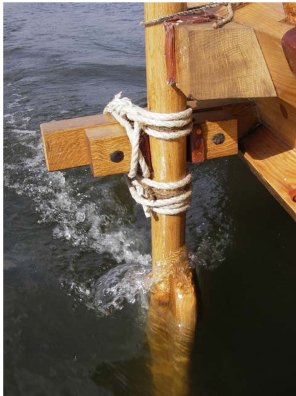
Abb. 17: Steuerbord-Ruderanlage bei Marschfahrt
