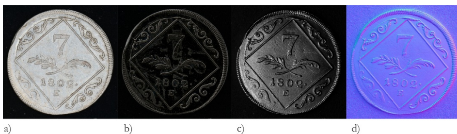
Fig. 2. Modalități de redare specifice metodei H-RTI: a. fără filtrare; b. Default enhancement ; c. Specular enhancement ; d. Normals visualization
