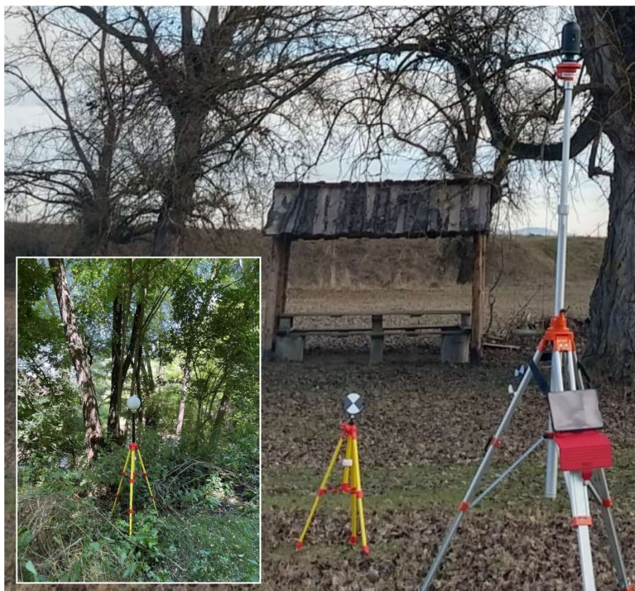
Fig. 4. Principalele tipuri de ținte folosite pentru referințierea internă și externă a norilor de puncte obținuți prin metoda TLS
