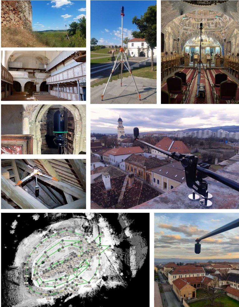
Fig. 1. Tipuri de stații de scanare și un exemplu de dispunere a lor în jurul bisericii fortificate de la Țapu (SB)
