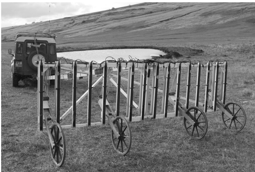
Fig. 4. Sistemul de prospecare geomagnetică cu 16 sonde.
