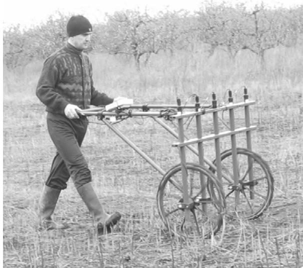
Fig. 1. Sistemul de prospectare geomagnetică cu 5 sonde.
