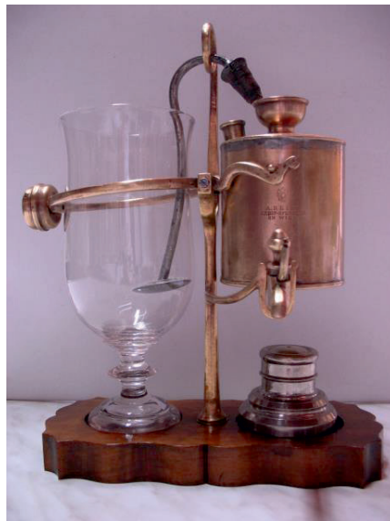
Foto 4: Aparat de preparat-distilat uleiuri volatile după restaurare
