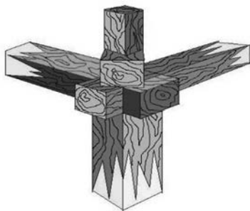
Fig. 42 – Structură de rezistență mixtă, cu stâlpi și bărne îmbinate cu „chiotori” – Seghiște, nr. 11
