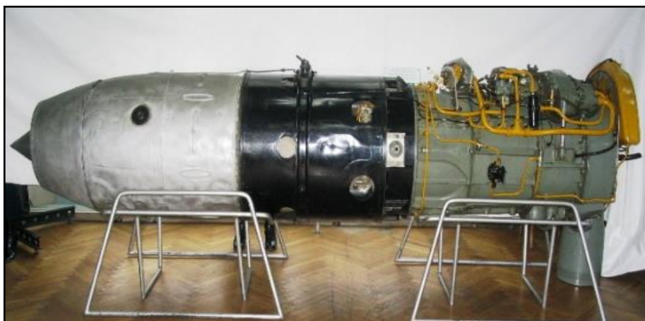
Motorul RD-10 care a echipat avionul YAK 17-UTI, cu numărul de înmatriculare 7, din colecția Muzeului Științei și Tehnicii „Ștefan Procopiu”, Iași, unul dintre puținele exemplare din lume păstrate; sursa foto: Muzeul Științei și Tehnicii „Ștefan Procopiu”, Iași.
