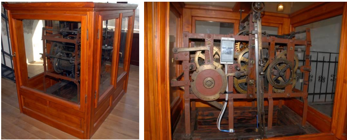
Fig. 4. Orologiul mamă (vedere generală). În detaliu se disting cele trei mecanisme ale forței – în ordine, de la stânga spre dreapta: mecanismul anunțării pătrarelor, având amplasat în față roata de calcul; mecanismul destinat mersului propriu-zis, cu pendulul în prim-plan, și mecanismul anunțării orelor întregi. De asemenea, se distinge și dispozitivul de întreținere electrică a oscilațiilor unui pendul.
