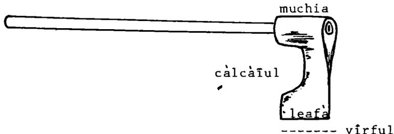
La hache à façonner se tient d'une main : pour un droitier, la partie gauche est rectiligne et la droite présente un seuil courbé. Le manche est recourbé pour laisser la main hors de la planche ou de la poutre. Il a la taille d'un avant-bras. Le bois doit être assis. Celle du charron se dit "oabla" et est droite. Celle du tonnelier, ("toaipa" en Moldavie) a une taille intermédiaire entre "secorea" et "barda".
