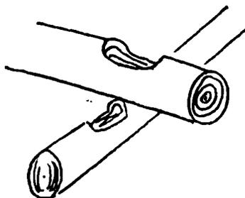
Le mur en poutres équarries est dit "în cheotori nemșeși" (assemblage allemand), pour cela on le dit d'origine saxonne. La technique semble avoir été utilisée d'abord sur les églises car on la dit aussi "în cheotori bisericesc" (assemblage d'église comme celle de Arheși, en Gorj, qui date de 1679). La même association existe pour le "queue d'aronde" français : on dit "coada de rîndunica" (queue d'hirondelle). L'anglais connaît "dovetail corner". Européanité des techniques du bois.
