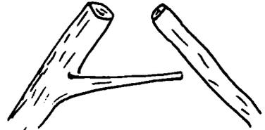
Une technique qui ne nécessitait pas le travail du perçage pour cheviller les poutres (donc vraisemblablement plus vieille que les techniques exigeant des outils de fer) est la construction en fourches ("în furci"). Elle existait dans le nord-ouest du pays (Satu-Mare, Salaj). La fourche de troncs entiers était utilisée pour soutenir les poutres ou pour soutenir la poutre faitière : "slemea".
