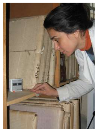
4. Detaliu din depozitul CNM „Astra”. Termohigrograf digital (Data Logger)
