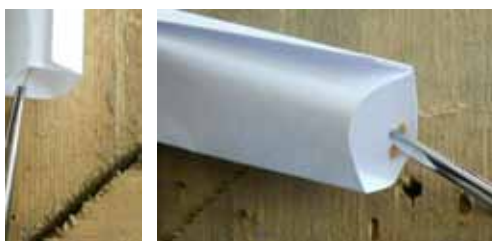
Aspecte din timpul prelevării probelor în vederea efectuării investigațiilor biologice la ramă și capac
