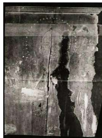
Imagine cu semnal radiografic puternic. Se observă defectele de prelucrare a suportului acoperit cu grund
