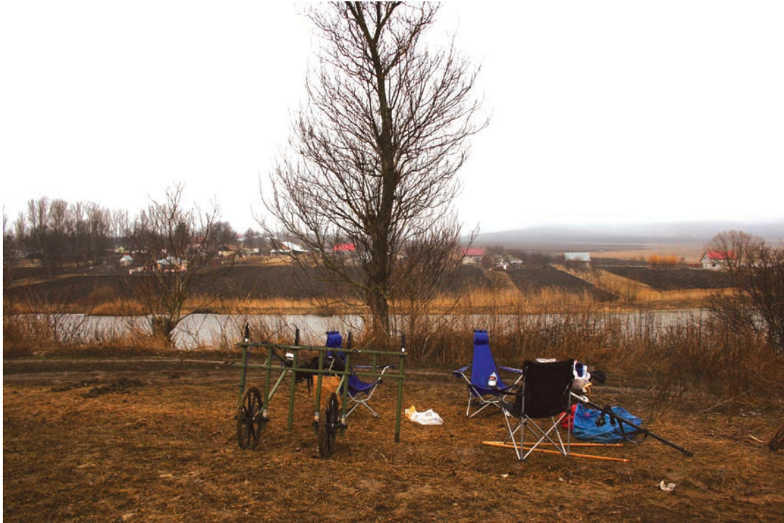
Fig. 1. Magnetometrul cu cesiu și vedere spre lacul din partea de N a sitului.
