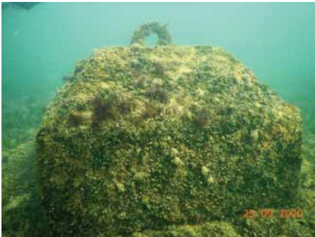
Fig. 1. Lest de beton – obiectul indică pe scanarea multibeam și pe cel de tip side-scan o anomalie, verificarea a confirmat prezența acestui obiect pe fundul mării.
