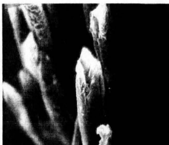
Figura 5.19 Aspectul zonei de rupere (tip 11) a unui filament din proba IV ( \times 3000 ).
