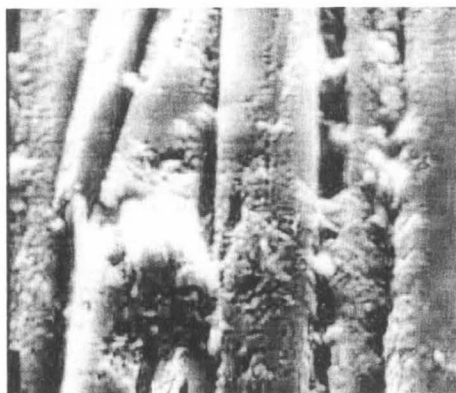
Figura 5.3 Aspectul suprafeței filamentelor din proba II vizualizat prin microscopie electronică cu baleiaj ( \times 3000 ).
