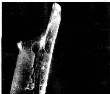
Figura 5.22 Aspectul zonei de rupere (tip 7) a unui filament din proba II ( \times 3000 ).
