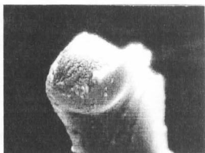
Figura 5.8 Aspectul zonei de rupere (tip 5) a unui filament din proba V ( \times 4800 ).
