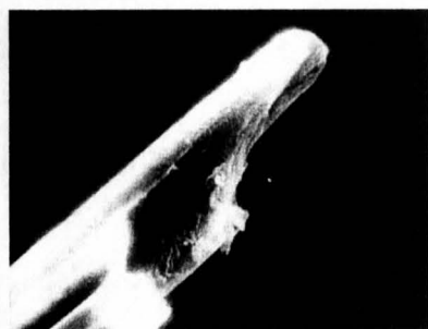
Figura 5.20 Aspectul zonei de rupere (tip 11) a unui filament din proba II ( \times 3000 ).
