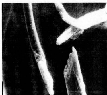
Figura 5.26 Aspectul zonei de rupere (tip 12) a unui filament din proba II ( \times 3000 ).
