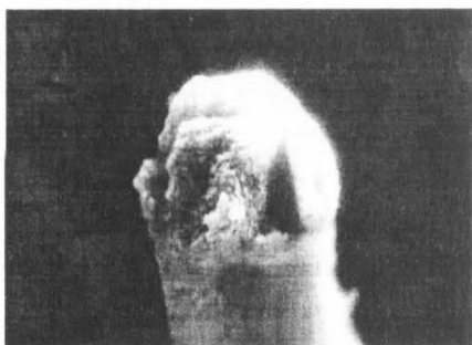
Figura 5.10 Aspectul zonei de rupere (tip 5) a unui filament din proba V ( \times 4800 ).
