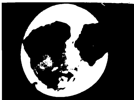
Figura 5.38 Secțiunile transversale ale unor filamente de mătase din proba IV ( \times 4200 ).
