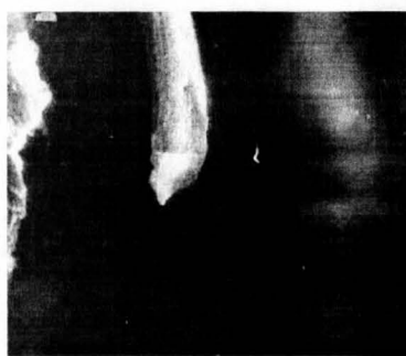
Figura 5.25 Aspectul zonei de rupere (tip 2) a unui filament din proba V ( \times 3000 ).
