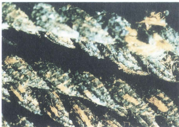
Figura 4.8 Produși de coroziune pe fire de cupru aurit, descoperite de Botoșani
