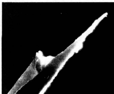
Figura 5.23 Aspectul zonei de rupere (tip 7) a unui filament din proba III ( \times 3000 ).
