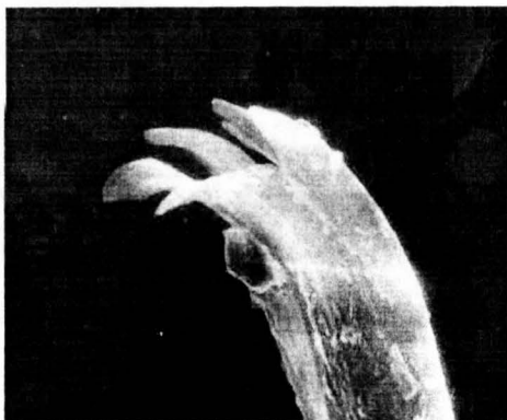
Figura 5.28 Aspectul zonei de rupere (tip 12) a unui filament din proba II ( \times 3000 ).
