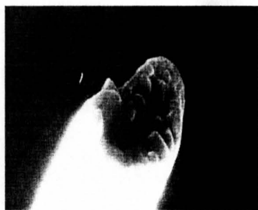
Figura 5.15 Aspectul zonei de rupere (tip 8) a unui filament din proba II ( \times 4500 ).
