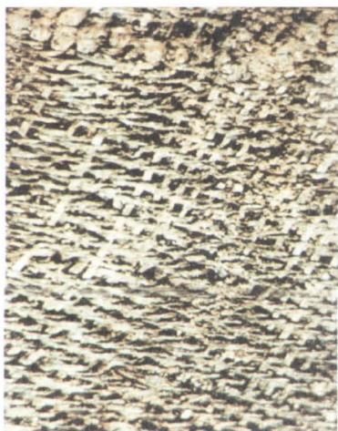
Figura 4.9 Produși de coroziune pe o țesătură din fire de mătase naturală și fire metalice, descoperită la Iași (sec. al XVII-lea)
