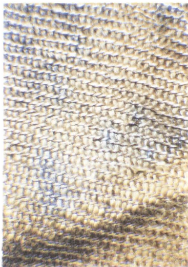
Figura 4.4b Țesătura cu depuneri de produși de coroziune – detaliu
