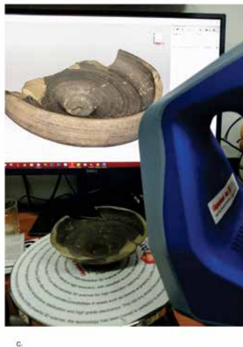
Fig. 10. Un exemplu reprezentativ cu rezultatele scanării 3D și utilizarea modelului mesh în realizarea ilustrației arheologice a unor artefacte descoperite pe sit: a) modelul mesh 3D de detaliu, inclusiv cu secționări de axe (XZ); b) perspective ortografice cu modelul 3D texturat; aspecte din procesul de scanare, folosind scanner-ul Artec SpaceSpider.
