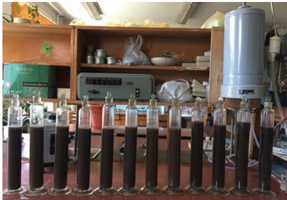
Fig. 9. Procesul de determinare a componenței granulometrice a solului în laborator (Universitatea de Stat din Moldova).
