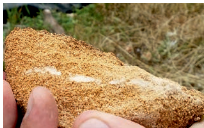
Fig. 11. a - Calcar oolitic-fosilifer utilizat la zidărie (foto V. Cetean); b - blocuri dimensionate de calcar oolitic-fosilifer (foto C.C. Roman); c - canelură în formă de „coadă de rândunică” pentru tiranții de sprijin intern ai paramentelor (foto C.C. Roman).
