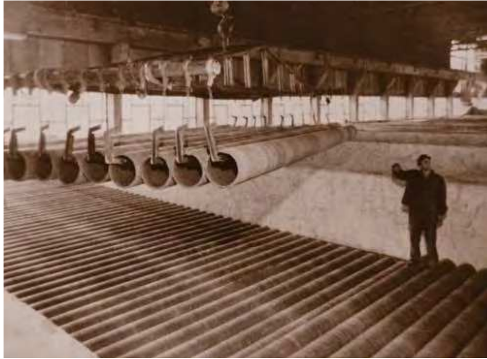
Instalația pentru fabricarea tuburilor de azbociment – maturizare
