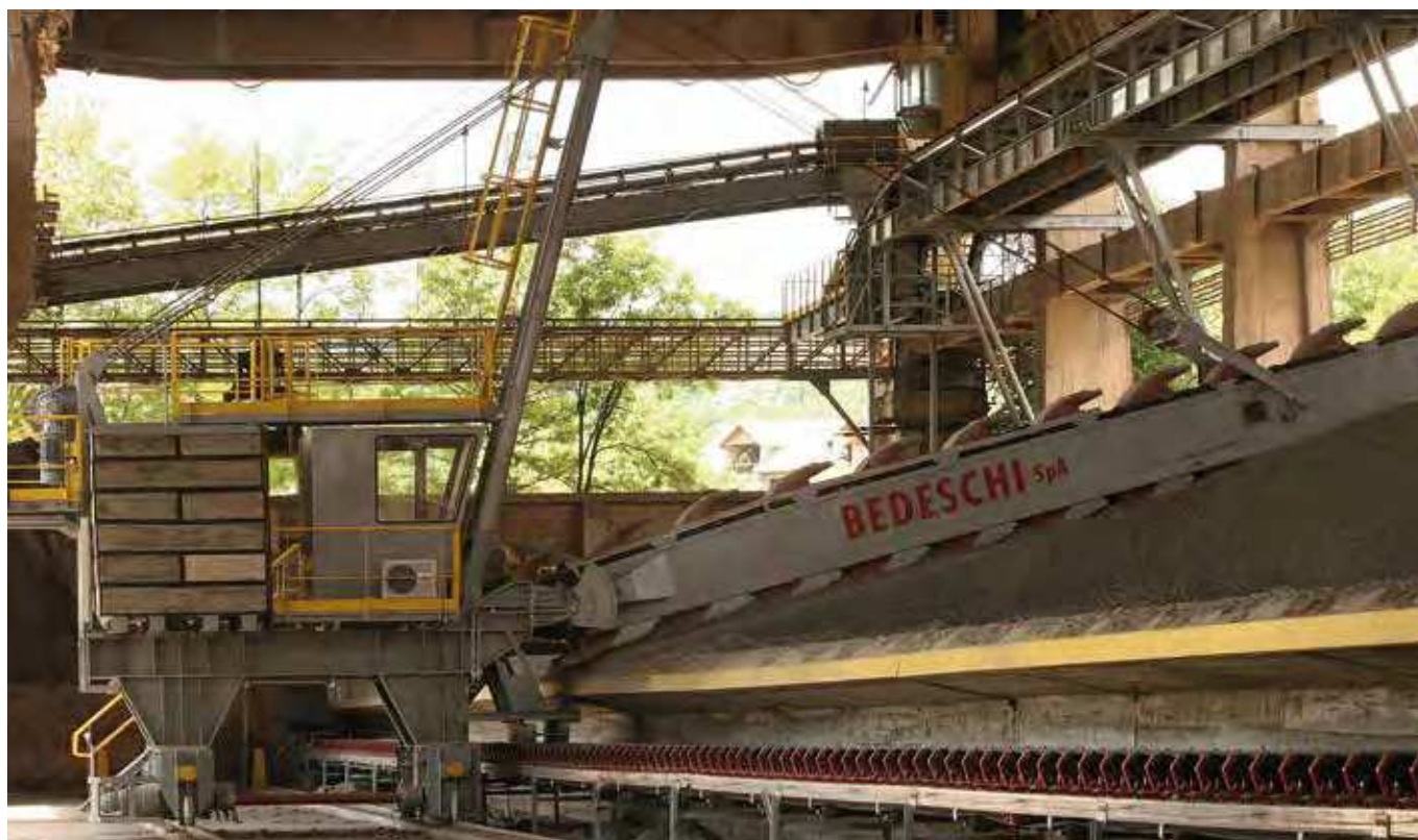
Instalația reclaimer BEDESCHI pentru preomogenizarea mamei Marl pre-homogenisation – Bedeschi reclaimer
