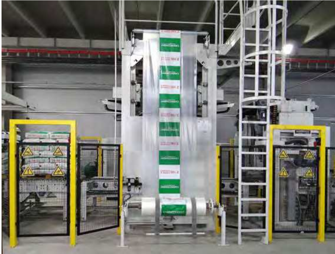
Instalație pentru paletizarea cimentului de zidărie Z 100
