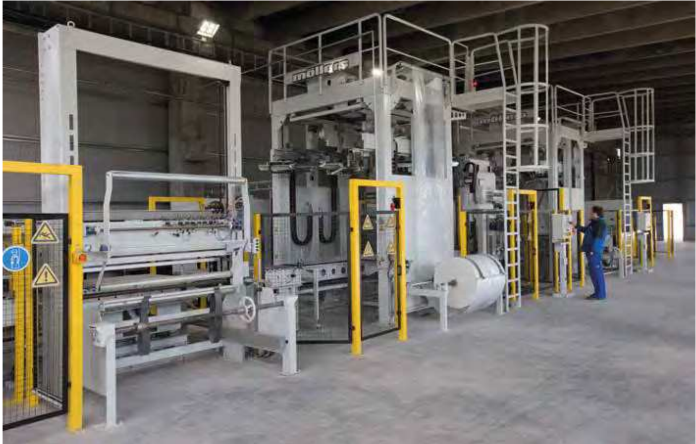
Instalație pentru paletizarea cimentului de zidărie Z 100
