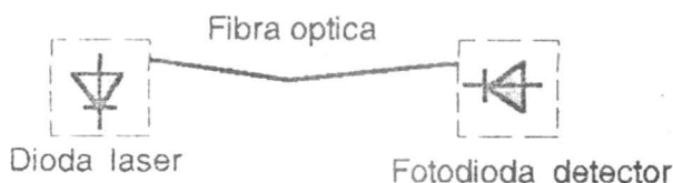
Fig. 51 Elementele principale ale unui sistem de comunicații prin fibre optice.
