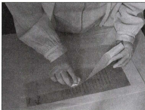
10. kép. Lágyítás glicerín-desztillált víz 0,5%-os oldatával
