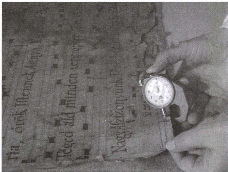
15. kép. Papírvastagság-mérés tapintóműszerrel
