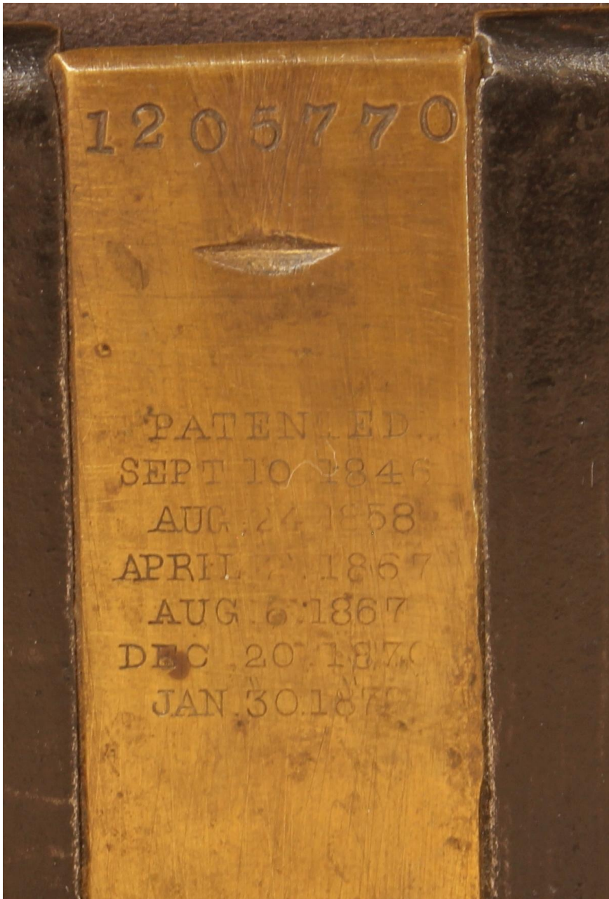
Fig. 4. Placă glisantă din alamă cu numărul de serie și datele de brevetare ale mașinii de cusut Howe.
