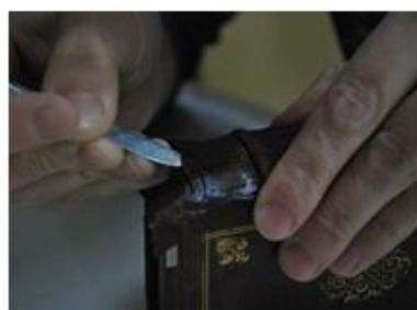
Fig. 14. Formarea capului cotorului
