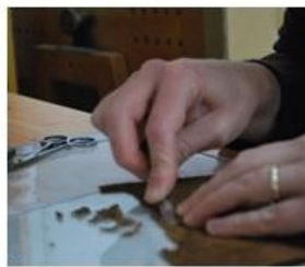
Fig. 11. „Șeșuirea” (subțierea) marginilor pielii de completare
