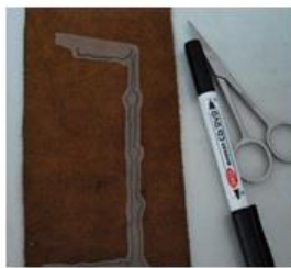
Fig. 10. Crearea completării de piele cu ajutorul unui șablon de folie
