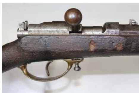
Fig. 5. Închizătorul și camera de ardere înainte de restaurare
