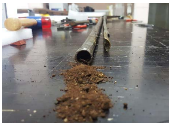
Fig. 9 – Detaliu produși de coroziune, vâșelină ancrasată
