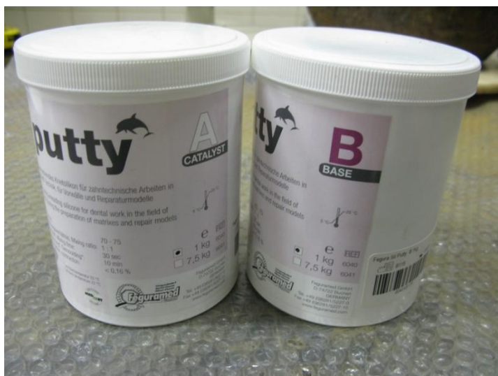
Fig. 4. Cauciuc siliconic de amprentare dentară, de tip Putty A+B, cu A = catalizator și B = bază
