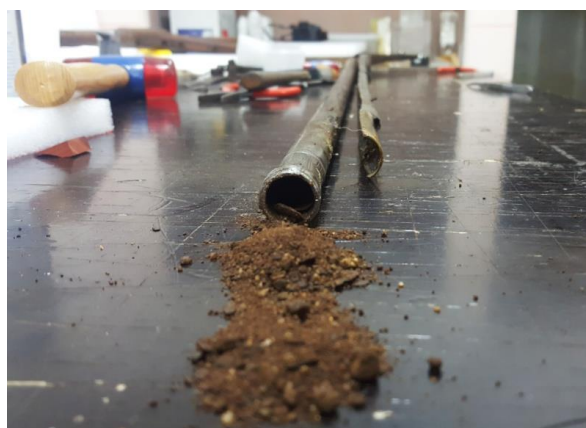
Fig. 9 – Detaliu produși de coroziune, vaselină ancrasată
