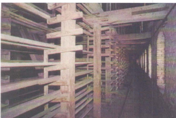
Fig. 6: Etaj – structură din lemn pentru uscarea cărămizilor
