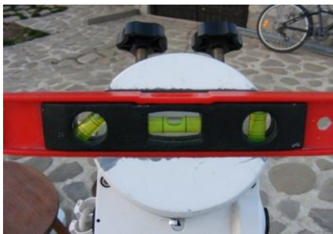
Imaginea nr.11 Verificarea orizontalității pe declinație
