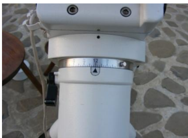
Imaginea nr.9 Poziția HOME corectă pe ascensie
