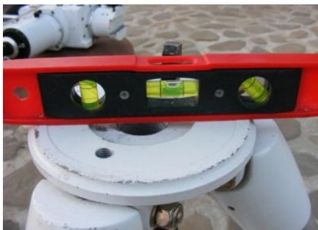
Imaginea nr.6 Reglaj realizat pe a doua direcție
