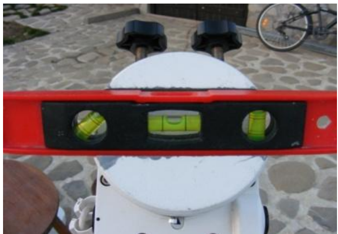
Imaginea nr.11 Verificarea orizontalității pe declinație
