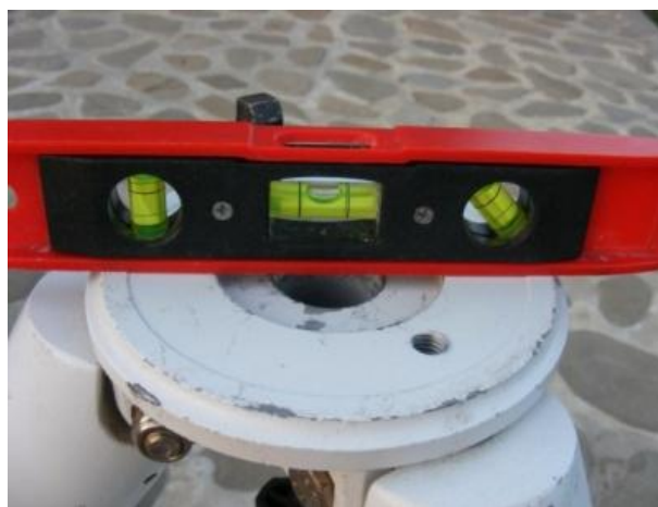
Imaginea nr. 7 Reglaj realizat și pe a treia direcție
