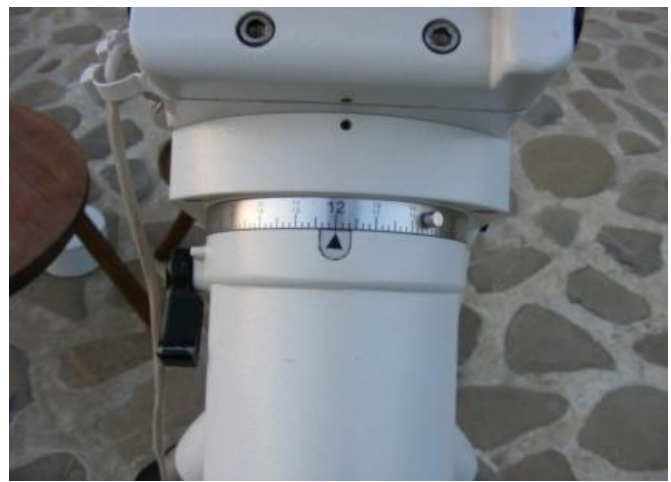
Imaginea nr.9 Poziția HOME corectă pe ascensie
