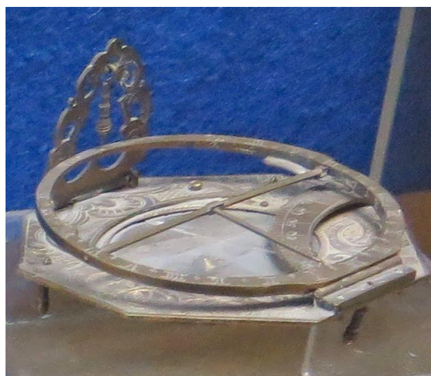
Imaginea nr. 2 Cadran solar ecuatorial portabil
