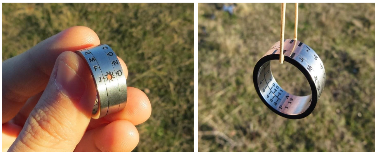
Imaginile nr. 3 - 4 Cadran solar ultra-portabil (în formă de inel metalic)
