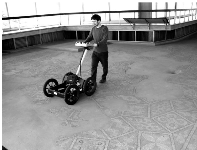
Investigarea prin metoda GPR a mozaicului Roman din Constanța
