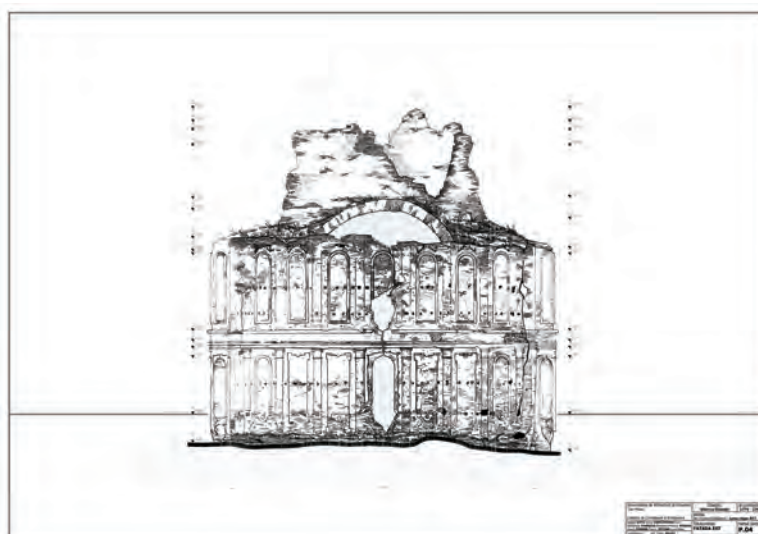
Fig. 17. Ruina bisericii Mănăstirii Giulești: fațada Est. Releveu redesenat și completat de stud.-arh. I. Butu, 2009
