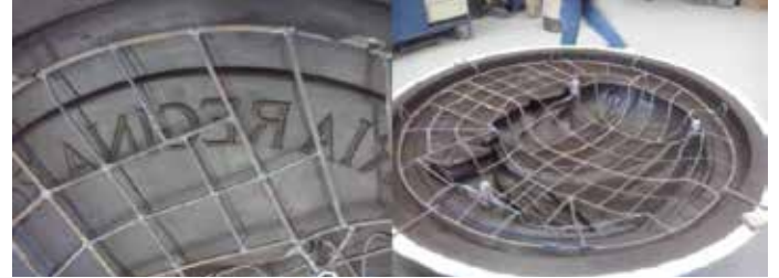
Fig. 13 Efigiile Regale Etapa V/2015, imagini înainte de turnare. Cele două efigii din bronz demontate de pe arc, realizându-se matrite pentru turnarea în simipiatră de sculptor – restaurator Alexandru Siminic. (Credo Design, 2015)
