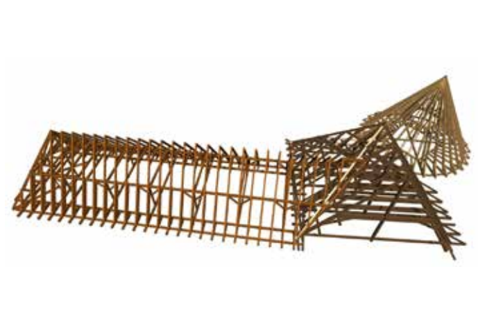
Fig. 6 Modelarea 3D în Archicad a ansamblului șarpantelor aferente clădirii principale executate în anii 2009-2011 - colțul nord-vestic, aripa vestică și turnul nord-vestic (echipa Irod M, 2009)
