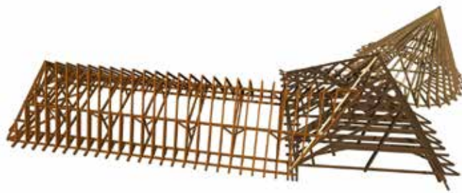
Fig. 6 Modelarea 3D în Archicad a ansamblului șarpantelor aferente clădirii principale executate în anii 2009-2011 - colțul nord-vestic, aripa vestică și turnul nord-vestic (echipa Irod M, 2009)
