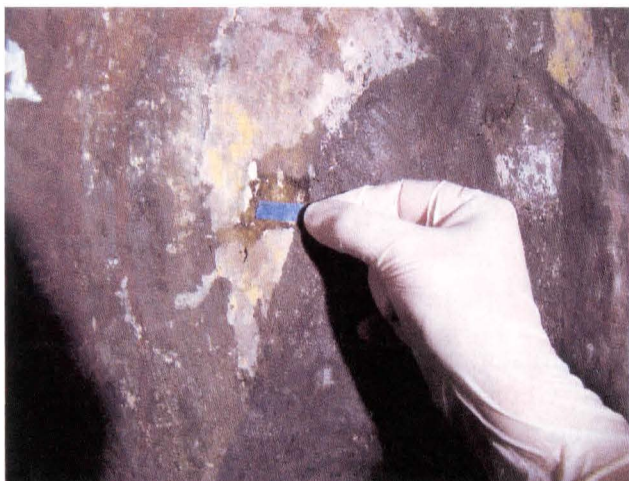
Fig. 10 Efectuarea testelor pentru identificarea valorilor pH-ului suprafeței picturii murale de la biserica Sfântul Nicolae – Popăuți
