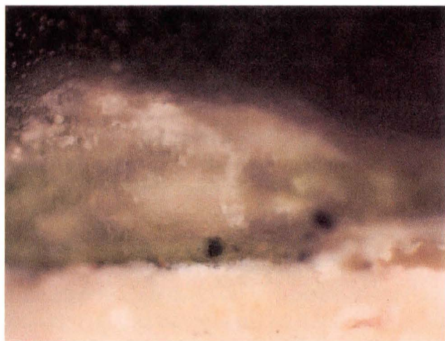
Fig. 9 Stratigrafia microprobei prelevate de pe fondul dintre medalioanele situate pe intradosul arcului de est – pronaos, partea sudică, zonă de îmbinare a celor două pontate, biserica Sfântul Nicolae Popăuți, X 100 – imaginea la microscopul optic în lumină incidentă relevă formarea sărurilor la suprafața stratului de intonaco (sub stratul de negru), în interiorul straturilor de culoare și deasupra acestora.
