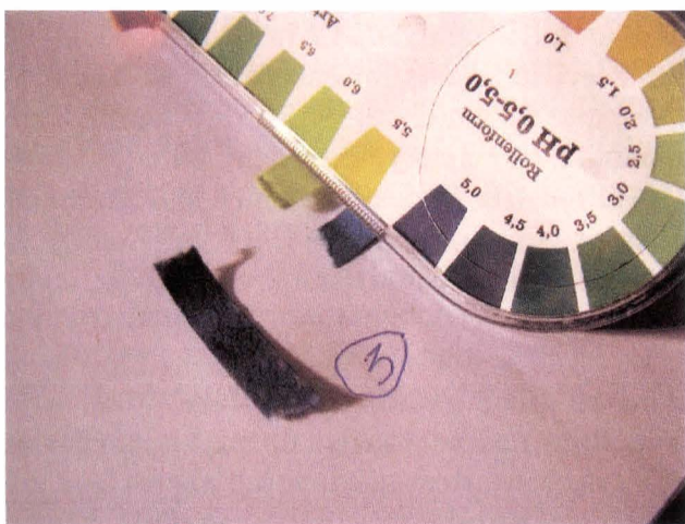
Fig. 11 Efectuarea testelor pentru identificarea naturii sărurilor de pe suprafața picturii murale de la biserica Sfântul Nicolae – Popăuți
