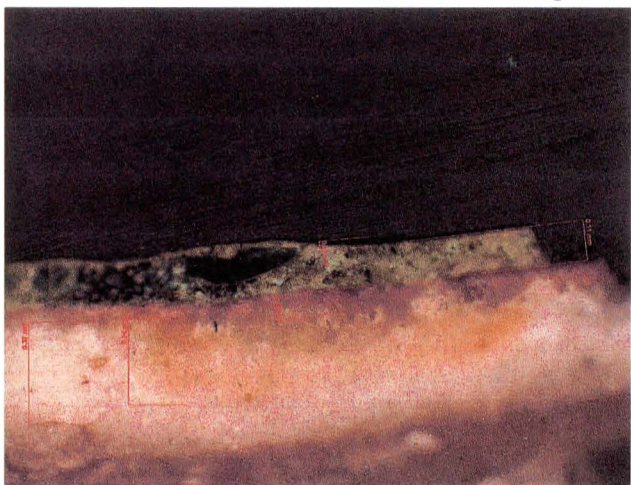
Fig. 5 Exemplu de stratigrafie a peliculei picturale, X 100 – imagine la microscopul optic în lumină incidentă, iconostas biserica Sfântul Nicolae Bălinești
