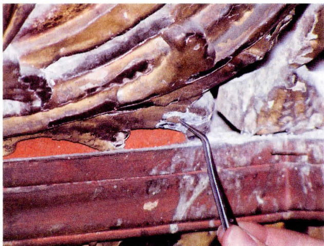
Fig. 2 Prelevarea microprobelor din zonele deteriorate ale foiței de aur, iconostas biserica Sfântul Nicolae Bălinești
