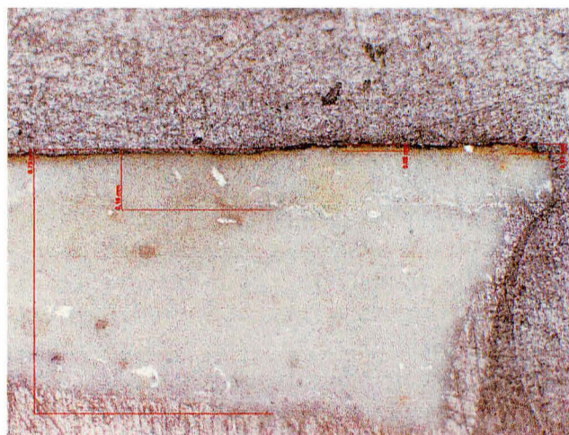
Fig. 3 Stratigrafia zonelor poleite cu aur, X 100 – imagine la microscopul optic în lumină incidentă polarizată, iconostas biserica Sfântul Nicolae Bălinești
