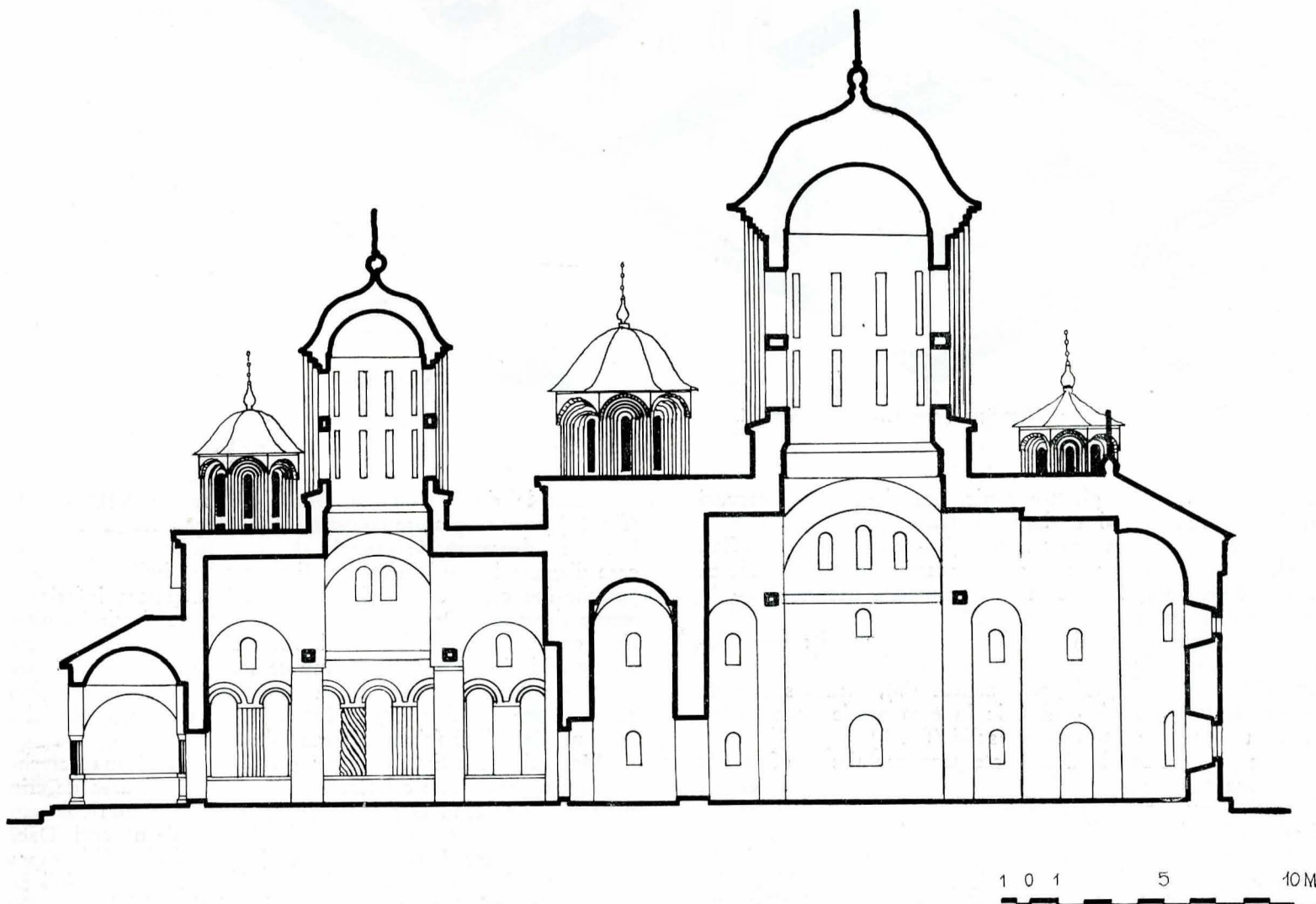
Fig. 4. Secțiune longitudinală a bisericii Mitropoliei din Tîrgoviște; încercare de reconstituire de arh. Cristian Moiescu.
