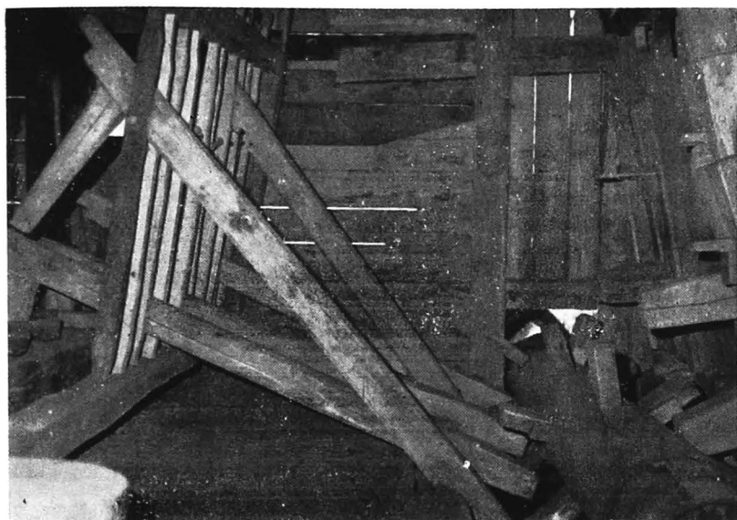
Piuă de haine și ulei, Tâlmăcel, jud. Sibiu. Detaliu — fusul și cio- canele pivei
