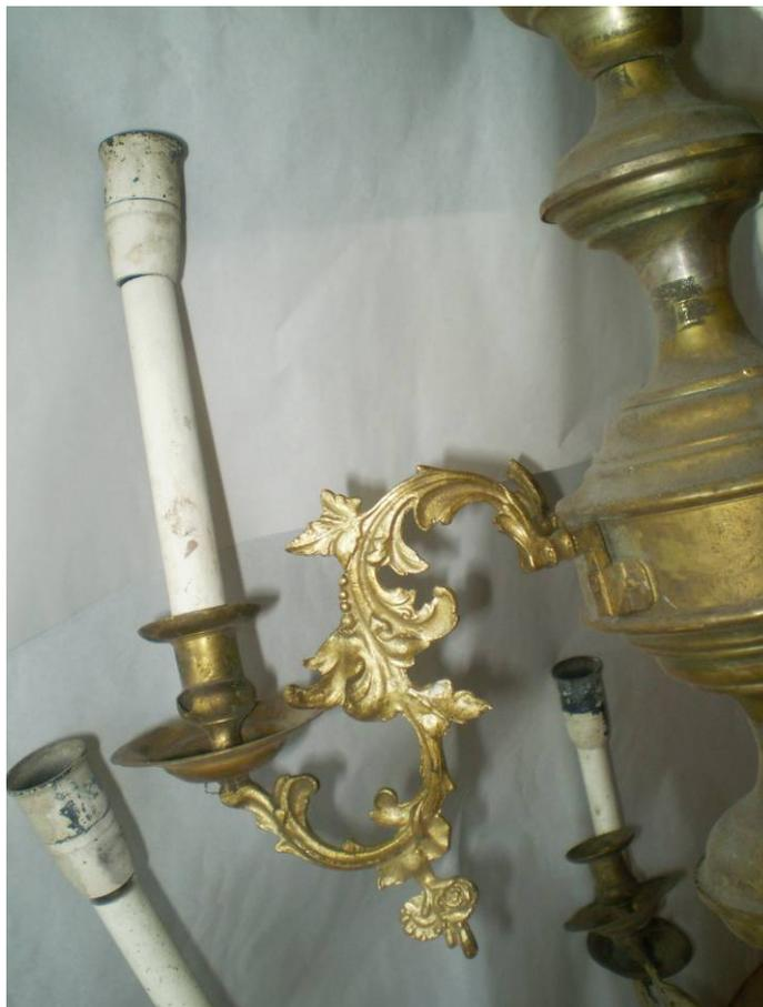
Foto 3. Deformarea brațelor candelabrului
