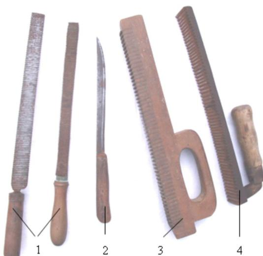
**21. kép.** A szaru anyag felületeinek a simítására, finomítására használt kézi szerszámok:
