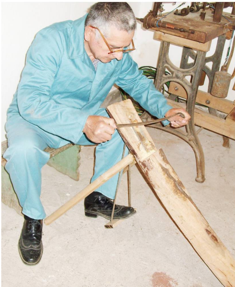
19. kép. A szarulap sikálásának művelete: 1 – sikálóbbak, 2 – leszorító kengyel, 3 – sikáló kés, 4 - szarulap
