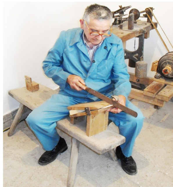
23. kép. Fésűfog vágása a két oldalán is fogazott nagy fogvágó fűrészszel
