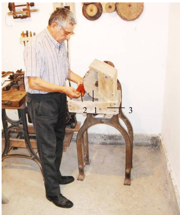
32. kép. A fésű gépi csiszolása: 1 – textil csiszoló korong a tengelyre szerelve, 2 – téglapor iszapba bemártott fésű, 3 – fadoboz az iszap tárolására
