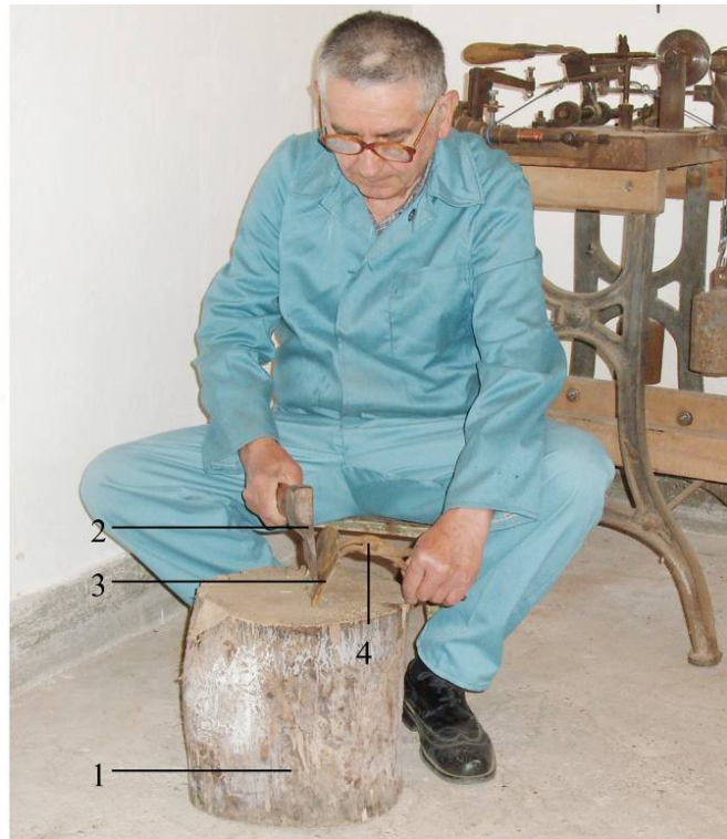
18. kép. A szarulap faragása: 1 – fatőke, 2 – szekerce, 3 – szarulap, 4 – görbecsőrű fogó
