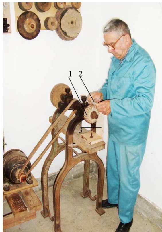
29. kép. Kracolás művelete: 1 – forgó krackerék (sorozatmaró), 2 – kézben tartott anyag, 3 – védő
