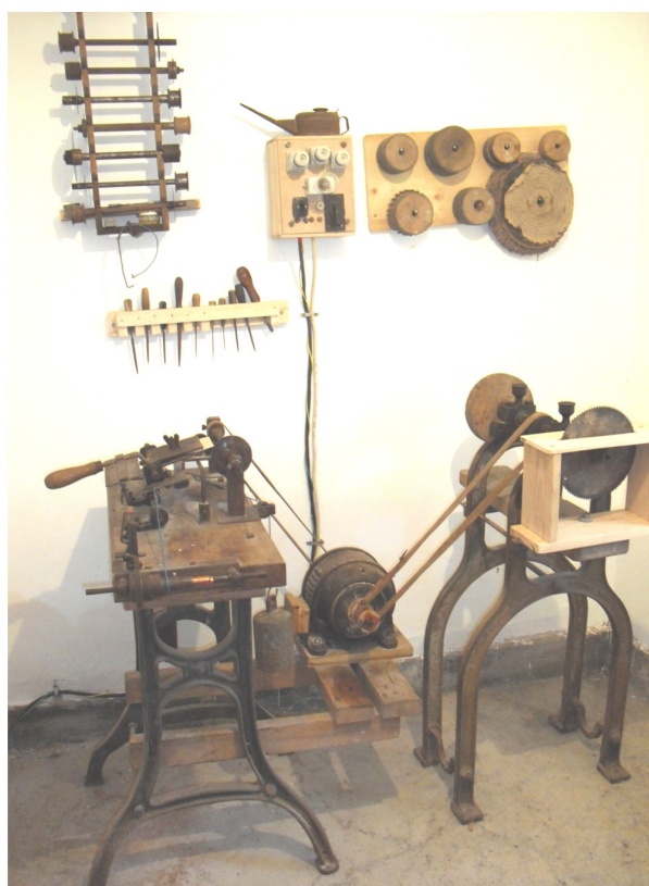
37. kép. Nagykárolyban első gépesített fésűs műhely két alapgépe egy motorról működtetve
