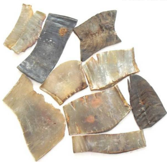
15. kép. A préslés után nyert kiegyenesített szarulapok
