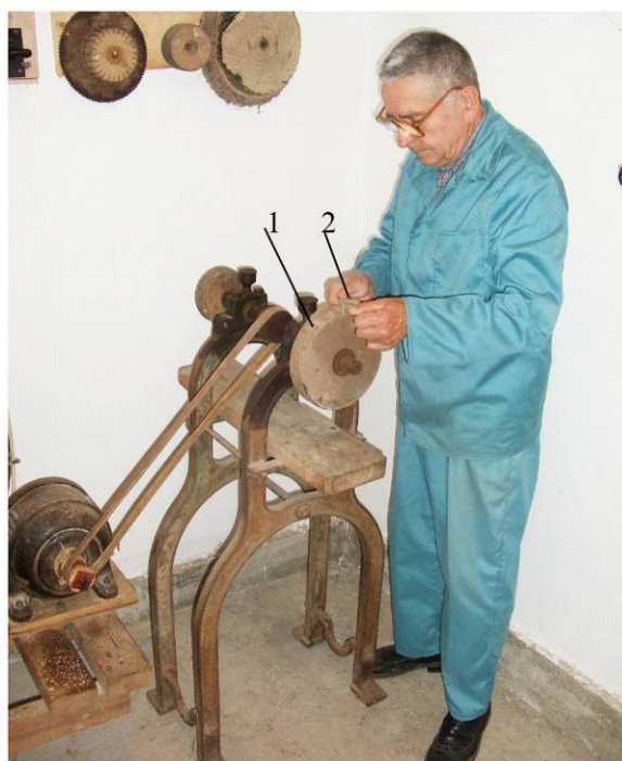
30. kép. A fésűnek kiszabott szarudarab fogvágás előtti méretre köszörülése: 1 – forgó köszörűkorong, 2 – kézben tartott szaruanyag
