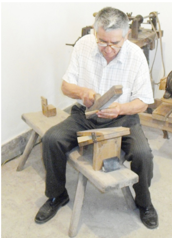
24. kép. A szarufésű fogvágás utáni finom hántolása
