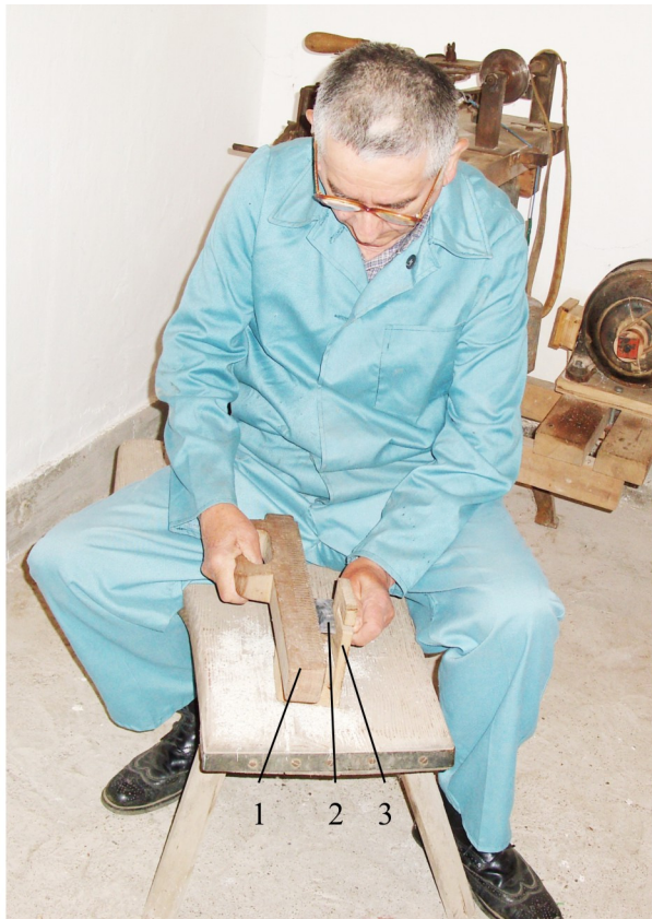
20. kép. A szarulap fogvágás előtti gyalulása, simítása: 1 – szarugyalu, 2 – fésűformájú szarulap, 3 – a műhelypad támasztója
