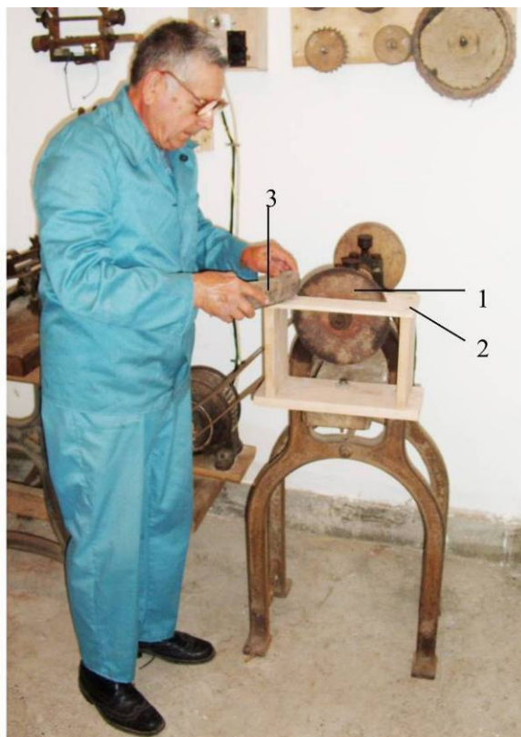
28. kép. A szaru darabolása: 1 – forgó körfűrész, 2 – anyagtámasz, 3 – kézben tartott szaru
