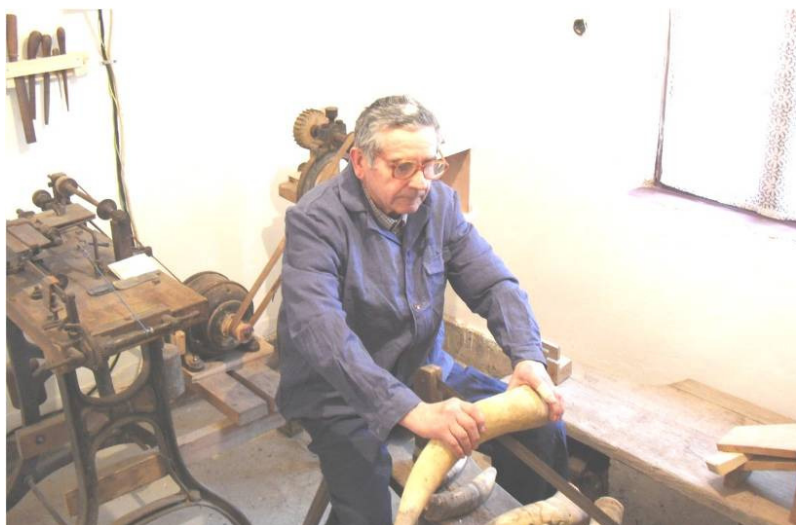
13. kép. A szaru darabolásának művelete 19. századból származó szerszámmal és technológiával
