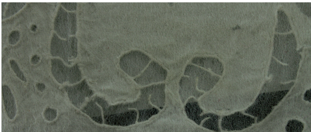
Perdeluță – detaliu de consolidare cu vâl de netex chimizat
