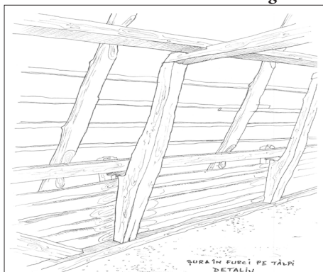
Fig. 9. Șura în furci din Gherța Mare. Detaliu de construcție. Desen de arh. Anca Bota
