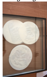
Fig. 10. Aspect fragmentelor textile după imersia în toluen
