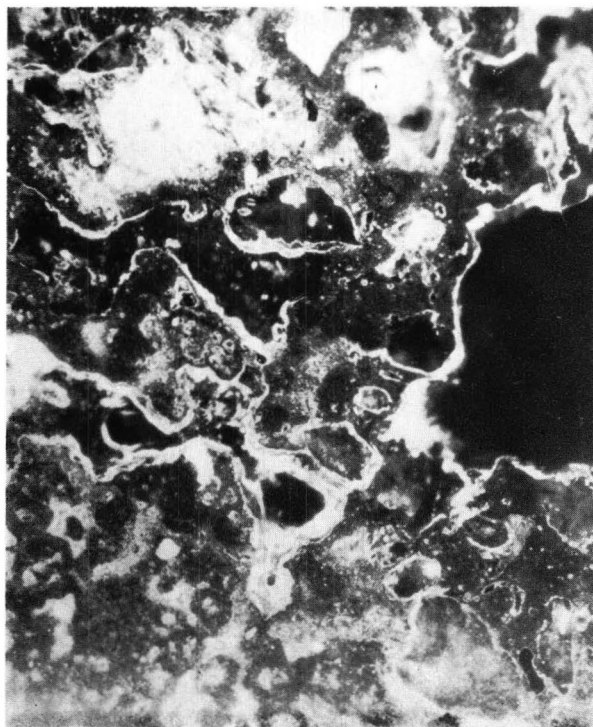
Fig. 2. — Aspectul secțiunii în lumină reflectată cu cimp negru. Hematita apare ca enclave gri-negricioase încete în masa mai deschisă sticloasă.
