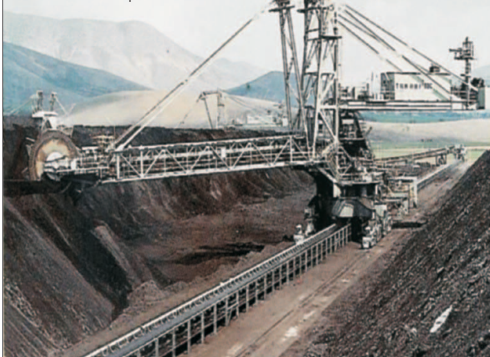
Fig. 10. Utilaj de depunere a cărbunelui în depozit
