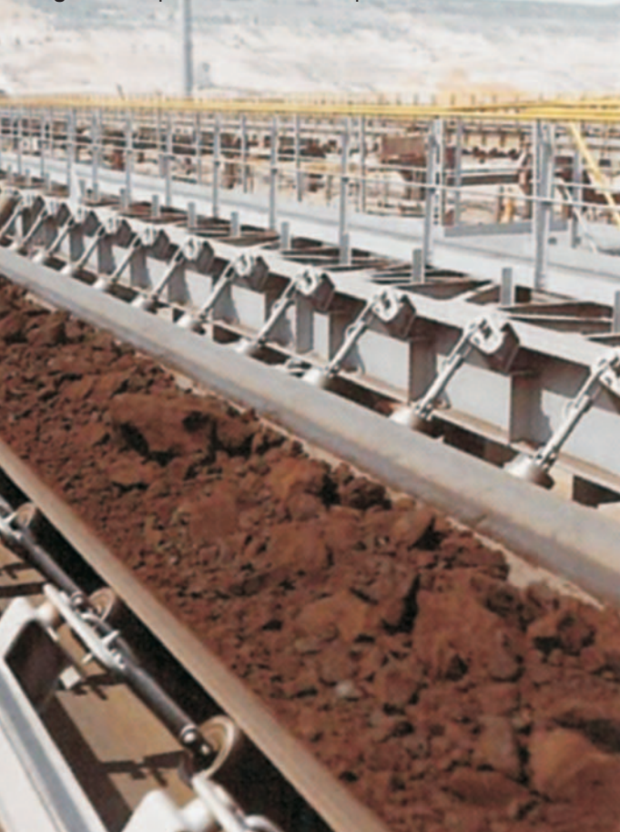
Fig. 8. Transportoare de mare capacitate folosite în cariere
