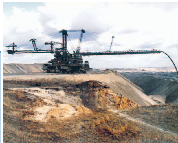
Fig. 9. Mașină de haldat folosită în carierele de lignit
